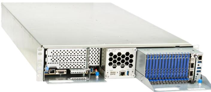
A capacidade das fontes de alimentação pode ser escolhida de acordo com a configuração e a potência necessária para a operação dos servidores instalados, sendo 800W e 1300W nos Chassis DM1904 ou 1300W para o Chassis DM1902. Em ambos os casos, fontes estão disponíveis nas versões AC ou DC.
